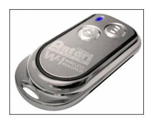
透過發射器,可於 50 公尺內的範圍控制煙霧輸出。所有的 W-1 發射器皆可與所有 HZ-350 內建的接收器相容,所以可以同時控制數量無上限的 HZ-350。按下 A 鍵可輸出,輸出時發射器上的 LED 燈亮起。按 B 鍵則可終止輸出。
